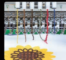
マルチコード装置 2 最大6色のコード素材を縫い付けるマルチコード装置 2も搭載可能です。 DCPによって縫い付けの表現は自由自在。
