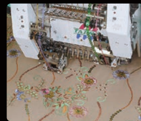
シークイン装置Ⅲ [ツインタイプ] (PAT) 高速回転で2種類のシークインを 任意に切替えて刺繍する装置
