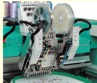
シークイン装置Ⅲツインタイプ サイズ、形状、色の異なる2種類のシークインを取り付けることができ、R側、L側の2箇所に着用すれば、1ヘッド最大4種類のシークインが刺繍できます。
