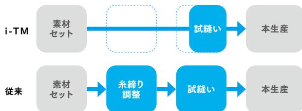
糸種を選ばず自動調整するためスピーディーに本生産が開始できます。
